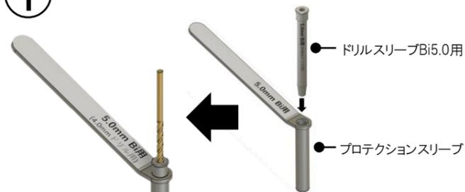
プロテクションスリーブ(外筒)とドリルスリーブBi5.0用(内筒)を組み合わせて、ドリルビットBi5.0用で下孔を穿ちます。
